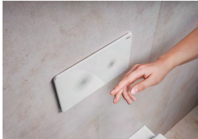
Die WC-Betätigungsplatte „Visign for Style 25 sensitive“ löst die Spülung komplett berührungslos aus. Einfach die Hand am jeweiligen grafisch hervorgehobenen Funktionsfeld vorbeiführen und die Spülung startet.
