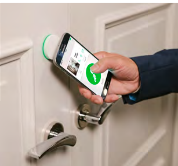
Eine Variante, Smartphones in Hotelzutrittslösungen einzubinden, ist, sie direkt für das Öffnen von Türen einzusetzen. Dazu nutzen viele Hersteller die Funkschnittstelle Bluetooth Low Energy (BLE).
